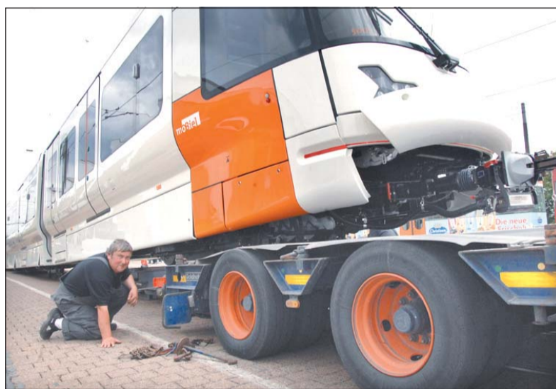
Matthias Helm beobachtet, wie der Vamos-Stadtbahnwagen langsam vom Schienenaufleger abgelassen wird. Fotos (3): Hans-Werner Büscher
