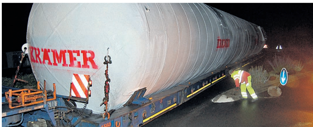
Damit der Schwertransport keine Bäume, Schilder oder Verkehrsinseln zerstört, räumt ein Zweimann-Trupp vorher die Straße großzügig frei, zum Beispiel in der Arolser Landstraße. In Twiste deinstalliert die Deutsche Bahn die Technik der zwei Übergänge, um die Fahrt möglich zu machen.
